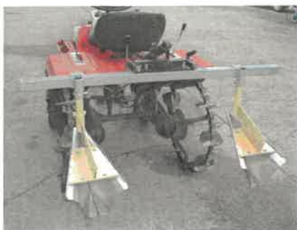
古い乗用田植え機に溝きりのアタッチメント (株)ホクエツ製) を取り付けた乗用溝きり機
