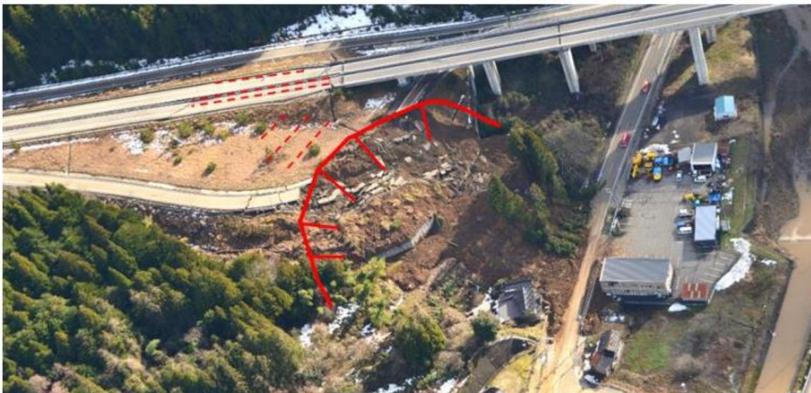
写真1. 盛土崩壊(穴水道路17.4kp付近)
