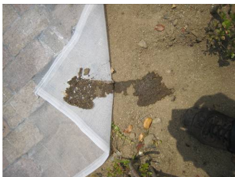
写真24 緩めた土を、寒冷紗+PVAでからめとる
