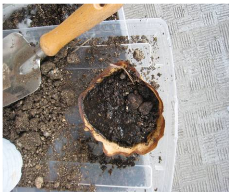
写真12 アルファ・デンプンで乾いた土を固めた様子、PVAより硬く固まる。
