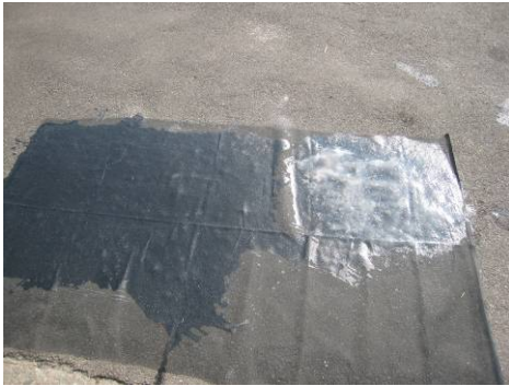
写真27 アスファルト道路表面の除染方法。 左側は（寒冷紗＋PVA）、右側は（デンプン＋寒冷紗）の様子
