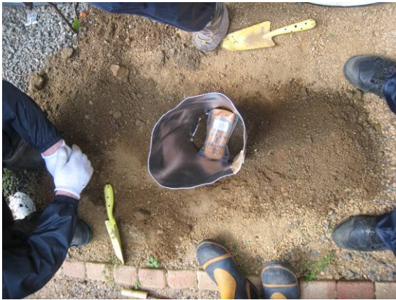
写真1 鉛版で囲んだ場合の測定の様子
