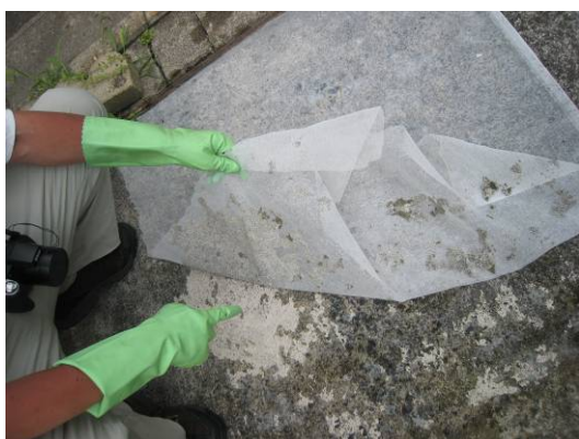
写真25 駐車場コンクリートからアルファ・デンプン+寒冷紗を剥がす。コンクリートの表面が剥離している。
