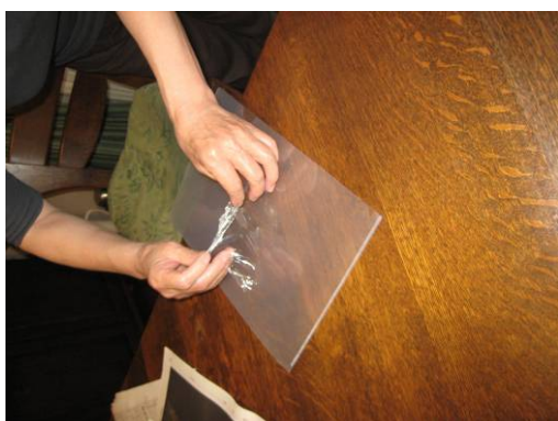
写真14 PVA液を滑らかな材質表面に垂らして乾燥させると透明の膜が形成され、それを剥がすと材質表面に付着していた汚れを除去できる。
