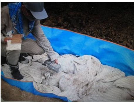
写真36 空間線量率の測定
