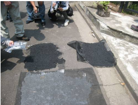
写真28 デンプン＋寒冷紗を乾燥後に剥がすと、 アスファルトそのものが剥ぎ取られた様子。 剥離効果が大きいことがわかる。
